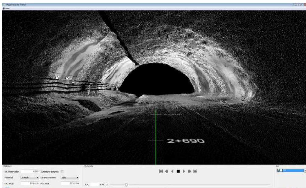
Mediante un panel se puede controlar la posición sobre el eje pudiendo avanzar, retroceder, parar, ir al primer o al último PK, o introducirlo directamente.
