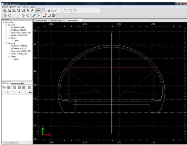
Es posible definir también la sección teórica del túnel, que puede constar de varias capas, mediante introducción numérica o bien importando un fichero DXF con las polilíneas que definen la geometría. Los vectores de la sección tipo pueden ser fijos, variables o peraltables.
