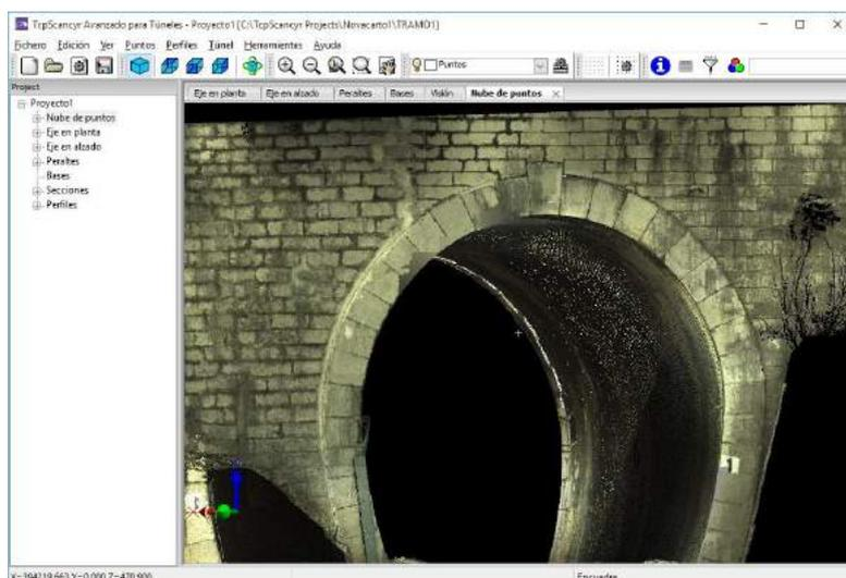
La simbología de los puntos puede configurarse por diferentes métodos, tales como por base, P.K., desplazamiento con respecto al eje, diferencia de cota con respecto a la rasante, ángulo, interior/exterior, distancia a la base, intensidad o bien por color natural.
