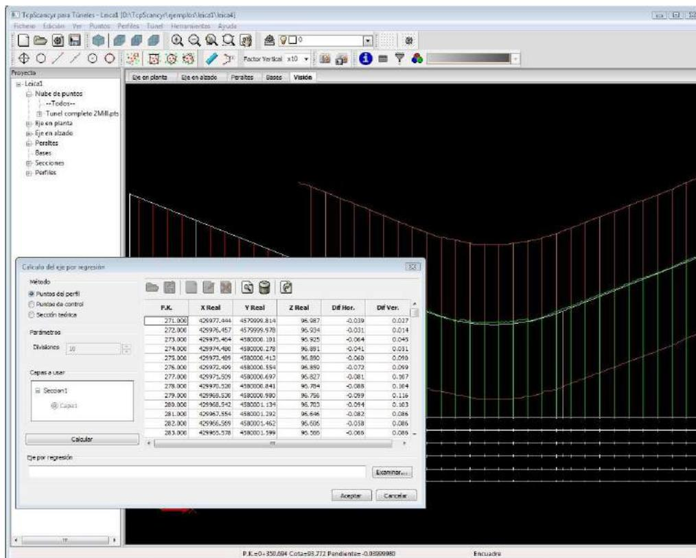
Además se genera un informe con diferencias en horizontal y vertical para cada capa, que pueden ser empleadas para controlar gálibos, etc. El resultado también se representa en planta y alzado, pudiendo comparar fácilmente el eje real y el de proyecto.
