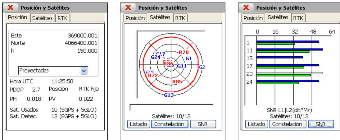
Además se puede obtener información detallada de la posición actual con coordenadas geográficas WGS-84 ó proyectadas, y gráficos en tiempo real de la constelación de satélites, diagrama de señal/ruido e información sobre la calidad del enlace de datos, distancia a la base, porcentaje de ambigüedades resueltas, etc.
