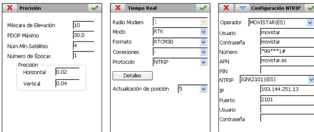
En todo momento se muestra información sobre la calidad de la posición, precisiones horizontal y vertical estimadas, número de satélites usados y detectados, estado de las baterías, indicador de recepción de correcciones, etc.
