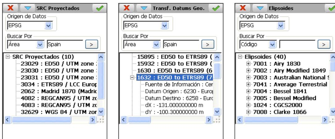
También se permite crear sistemas de coordenadas personalizados de distintas dimensiones (2D, 3D y 2D + 1D) a partir de pares de coordenadas origen y destino o introduciendo manualmente los parámetros de transformación procedentes de informes de ajuste de proyectos existentes. Ofrece la posibilidad de crear un informe detallado en formato HTML.
