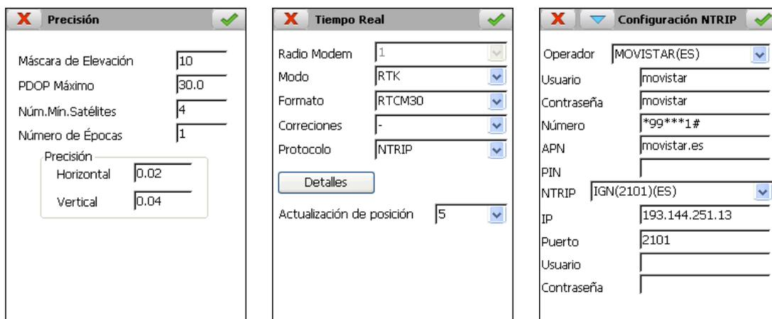
En todo momento se muestra información sobre la calidad de la posición, precisiones horizontal y vertical estimadas, número de satélites usados y detectados, estado de las baterías, indicador de recepción de correcciones, etc.
