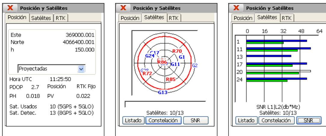
Además se puede obtener información detallada de la posición actual con coordenadas geográficas WGS-84 ó proyectadas, y gráficos en tiempo real de la constelación de satélites, diagrama de señal/ruido e información sobre la calidad del enlace de datos, distancia a la base, porcentaje de ambigüedades resueltas, etc.
